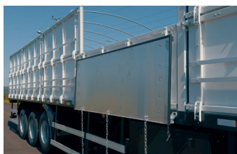
Tampas articuladas e removíveis com travamento por correntes
