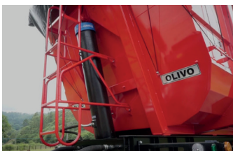
Sistema hidráulico com cilindro frontal
