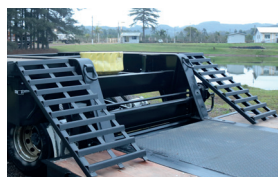
Rampa auxiliar de acesso a plataforma do pescoço
